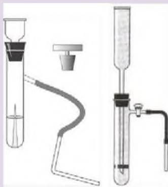
Рис. 7. Прибор для получения и собирания газов
